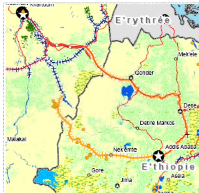
Figure 63. Tracé ferroviaire de la section Sennar – Addis Abeba (850 km selon une première variante et 1050 km selon une deuxième variante)
